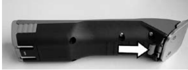
Fig. 6 Enclavamiento cabezal esquiladora
